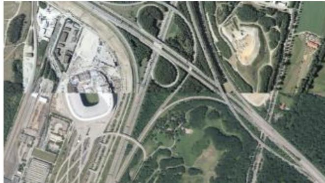
Jedes Befliegungsjahr wird hierbei als separater Layer bereitgestellt. Für die **Jahre 2003 bis 2005** liegen die DOP mit einer Bodenauflösung von **40 cm**, **ab 2006** mit einer Bodenauflösung von **20 cm** vor.
